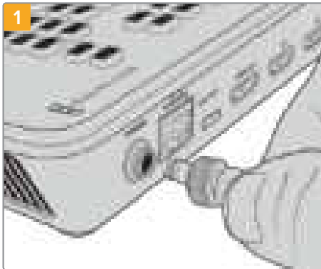
Conecte el mezclador a la red de suministro eléctrico mediante el cable provisto.
