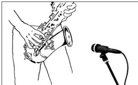
Fig. 1: Posicionamento do microfone para o saxofone.
