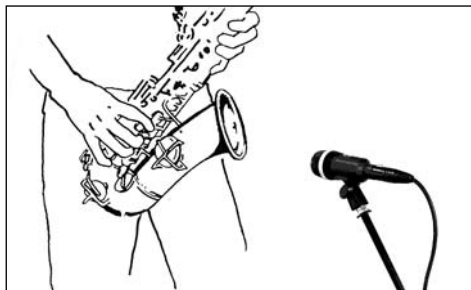
Abb. 1: Mikrofonaufstellung für Saxophon
