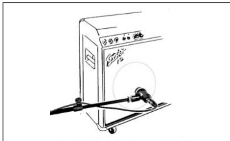
Fig. 3: Posizionamento del microfono per amplificatore per chitarra
