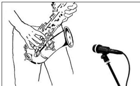
Fig. 1: Emplazamiento del micrófono para saxófono
