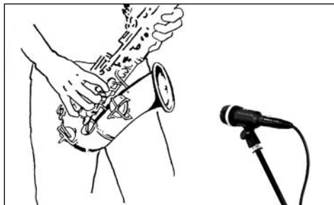
Fig. 1 : Position du micro pour le saxophone
